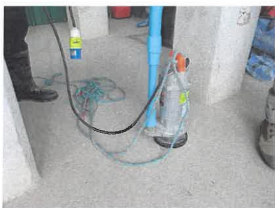
รูปที่ 2-33 เครื่องสูบน้ำ
